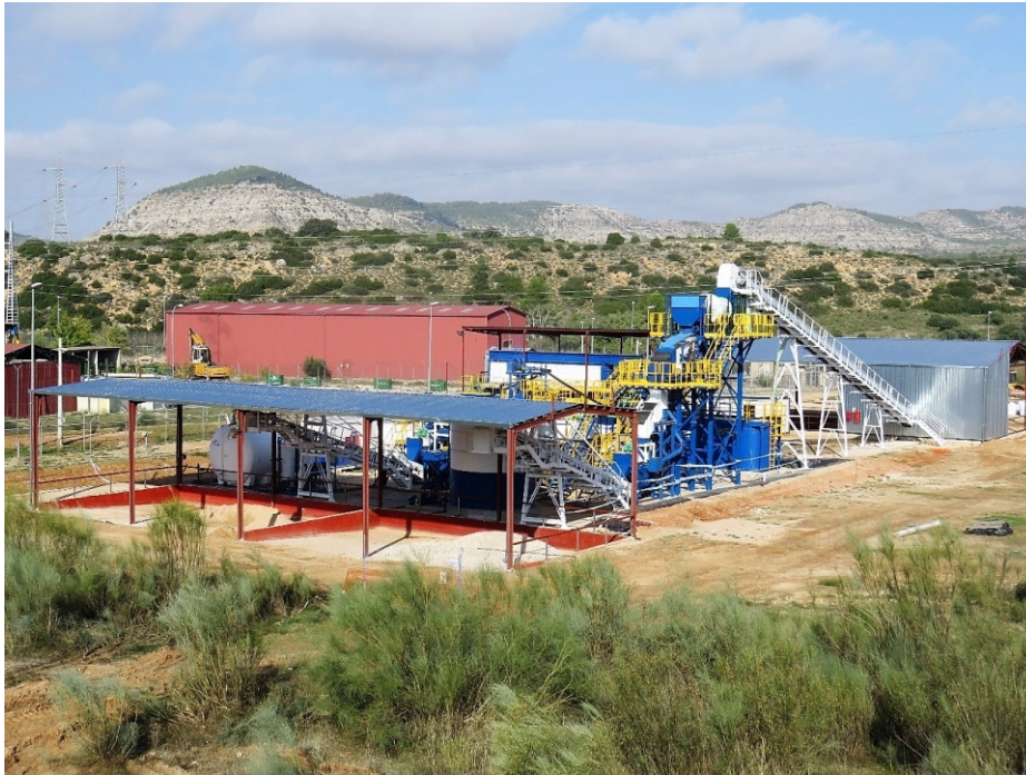
Imagen de la planta para el tratamiento de tierras en la central nuclear de José Cabrera.
